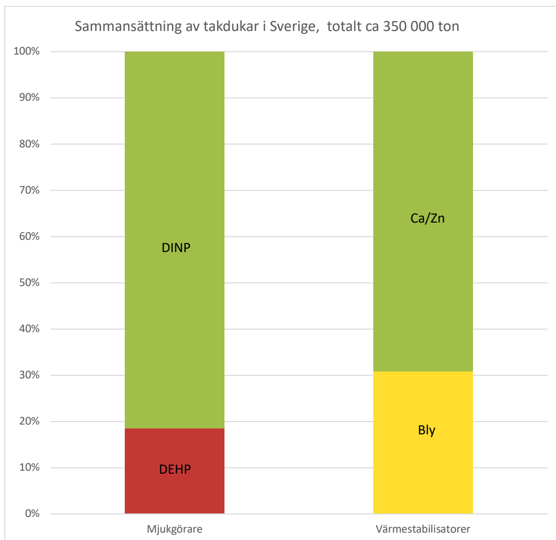
Figur 6: PVC Forums kategorisering av hur återvinningsbar den inbyggda mängden takdukar är uppdelat på innehållet av mjukgörare eller värmestabilisatorer. Gäller den inbyggda mängden vid årsskiftet 2017/2018. Baserat på siffror från IVL.
